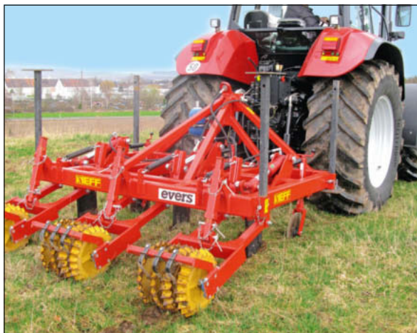
Der Grasnarbenlockerer hat Vorschneidseche, Untergrundlockerer und Rückverfestigungswalzen.
