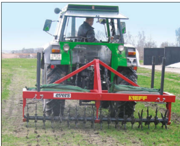
Der Grasnarbenbelüfter ist eine heckangebaute, bodenantriebene Igelwalze mit 3 m Arbeitsbreite.
