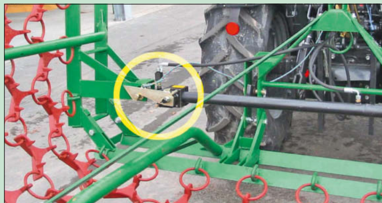
Durch eine Klinkensicherung kommt es beim Hochklappen der Seitenteile zur halb automatischen Arretierung.
