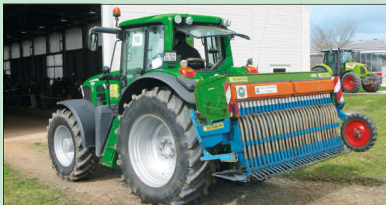
Die Köckerling Herbamat besitzt Schlitzmesser zur Narbenöffnung. Für gute Bodenpassung sorgt die Einzelaufhängung der Aggregate.
